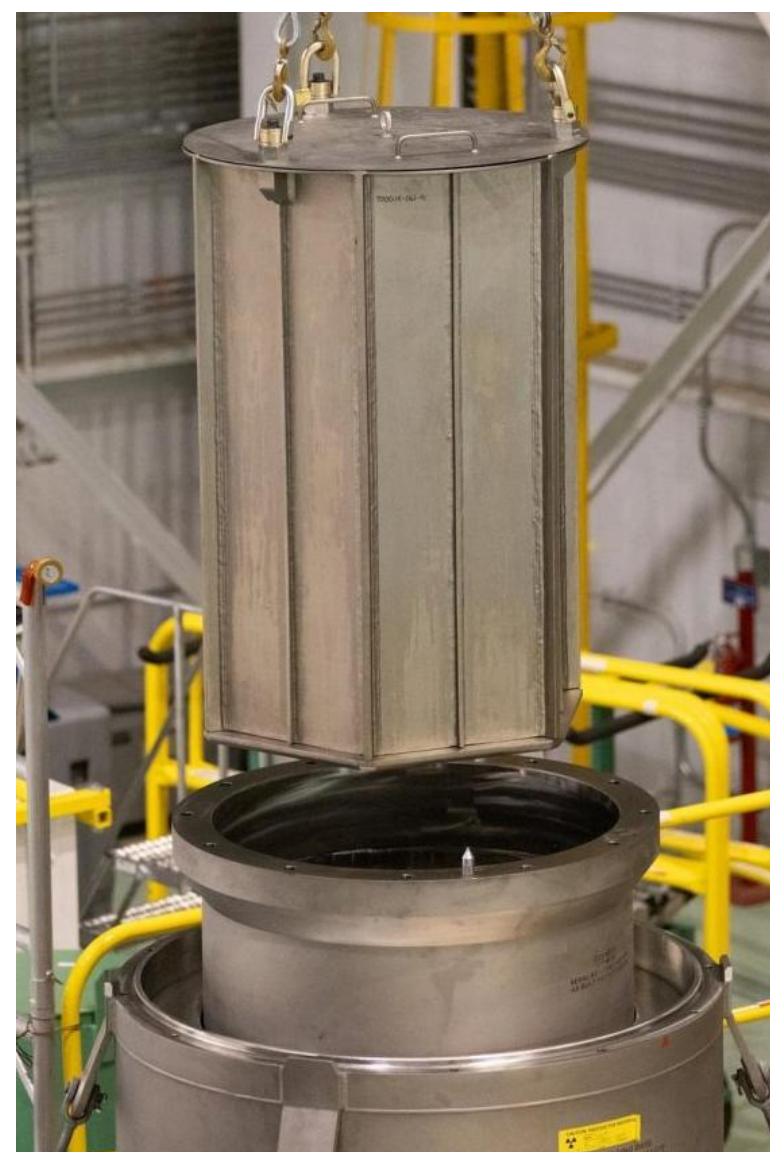
Figure n°4 : Un panier GEO, le conteneur intérieur du colis d'expédition, est retiré du conteneur de transport du navire de confinement. (INL 2025)
