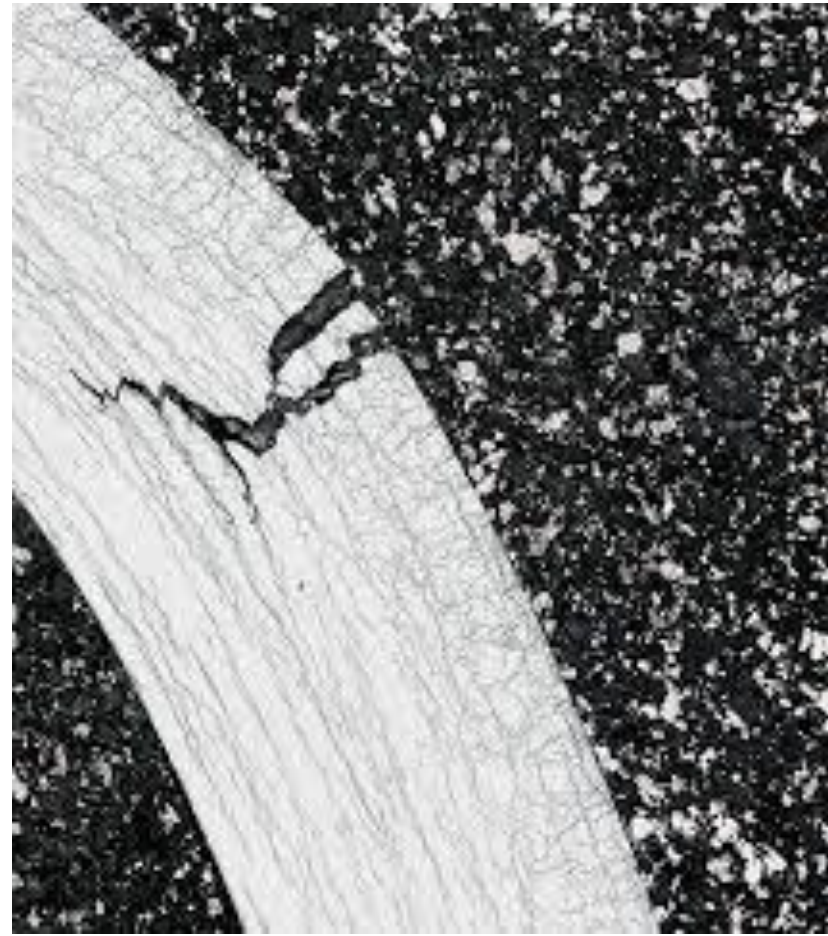
Figure 1: Rupture sur une gaine de Zircaloy en raison d'hydrures [3]
