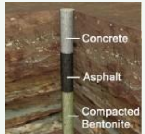
Figure 3 : Constitution du bouchon du forage (Brady, P.V.,2017)
