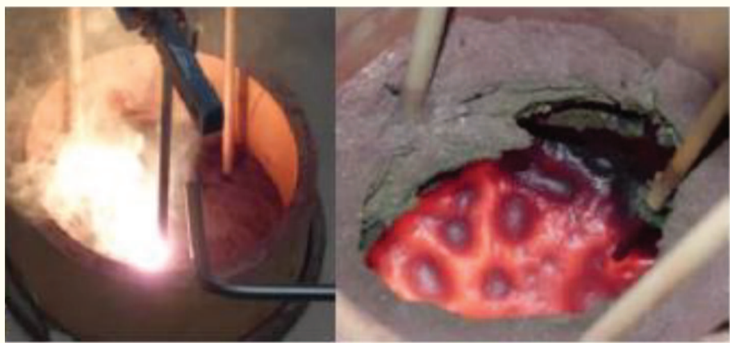
Fig. 1: Fabrication de corium sur installation PLINIUS [2]
