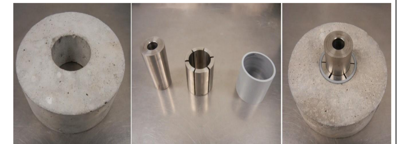
Illustration n°2 : Échantillons de mortiers fissurés A et B Source: Matériaux & Techniques 108, 303 (2020)
