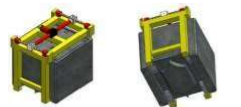
Figure 9 : Système de manutention de retrait de type Artéon (source: ANDRA)
