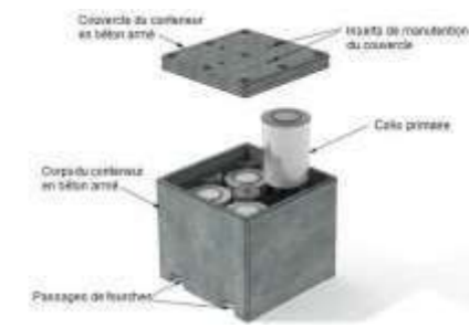
Figure 1 : Conteneur de stockage de déchets bitumés CS4 (Source: CEA)
