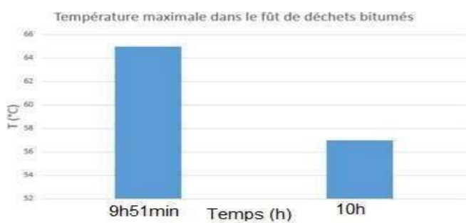
Figure 7: Température maximale dans le fût de déchets bitumés « scénarios court et long » (source :Andra)
