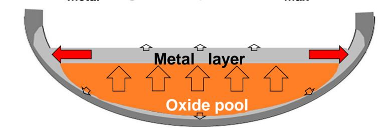
**Figure 5** : flux thermiques au fond de la cuve (source : personnelle, 2021)
