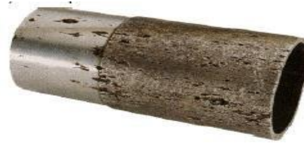
Figure 2 : Corrosion sous contrainte d'un tube en acier inoxydable (2)
